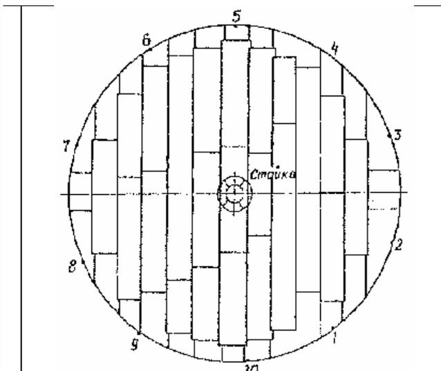
Рис. 4. Пример карт для обследования дна бака
