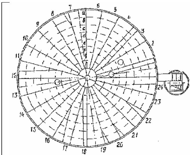
Рис. 3. Пример карты для обследования кровли бака
